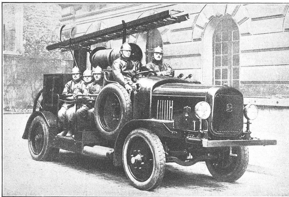
LA NOUVELLE POMPE A INCENDIE, DITE « DE PREMIER SECOURS », SYSTÈME DÉLAHAYE, DES SAPEURS-POMPIERS DE LA VILLE DE PARIS
