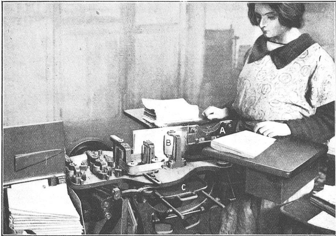
MACHINE SERVANT A COLLER LES ENCARTAGES
