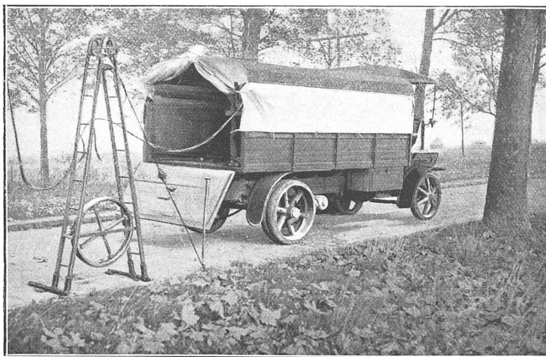
FIG. 5. — LES MACHINES SONT ALIMENTÉES PAR UN GROUPE ÉLECTROGÈNE SUR CAMION Le courant électrique est transmis le long de la route au moyen d'une canalisation supportée par des échelles isolantes doubles et pouvant être montée et démontée très rapidement.
