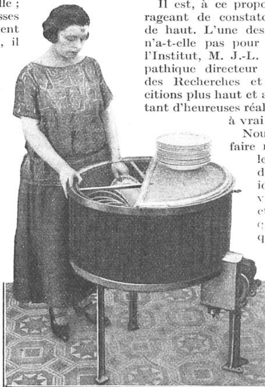
FIG. 1. — PETIT MODÈLE DE LA MACHINE À LAVER LA VAISSELLE, À PANIER TOURNANT ET POMPE CENTRIFUGE, IMAGINÉE ET MISE AU POINT PAR M. J.-L. BRETON, DE L'INSTITUT
