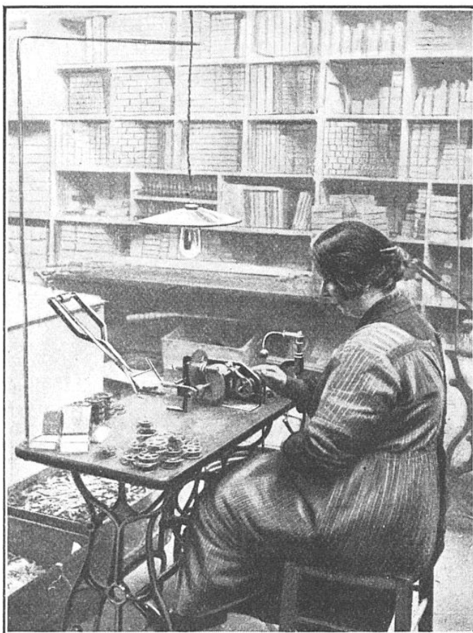
MACHINE POUR LE BOBINAGE DU RUBAN ENCRÉ, LA FORMATION D'UNE BOUCLE A L'UNE DE SES EXTRÉMITÉS ET LA POSE D'UNE AGRAFE A L'AUTRE, POUR SA FIXATION SUR LA MACHINE A ÉCRIRE
