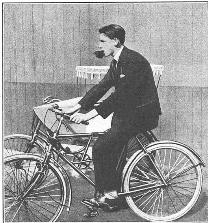
FIG. 1. — LA LAMPE DE « BOUCHE » DU CYCLISTE Photographie prise sur l'accoupleur de cycles de M. Lanfray.
