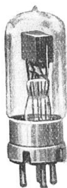
FIG. 7. LAMPE AN- GLAISE A PLAQUE DE SECTION RECTANGU- LAIRE
