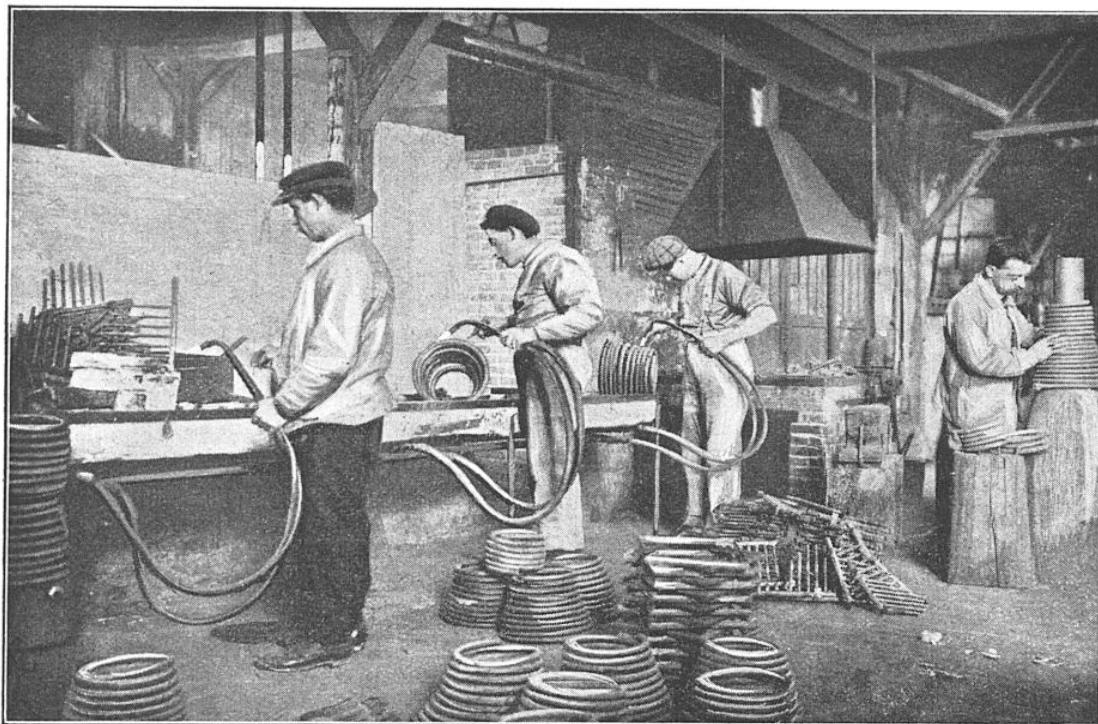
OPÉRATION DU BRASAGE, AU CHALUMEAU, DES DIFFÉRENTS SERPENTINS
