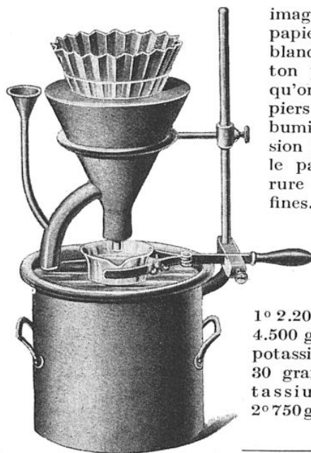
APPAREIL VOIRIN POUR LA PRÉPARATION DE L'ÉMULSION AU GÉLATINO-BROMURE D'ARGENT
