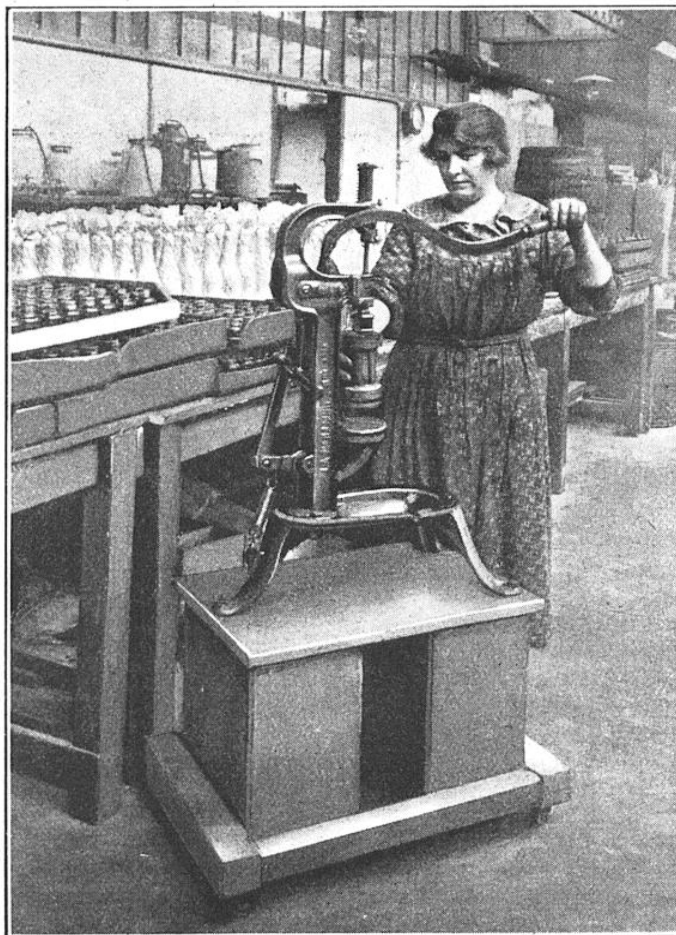
BOUCHAGE HERMÉTIQUE DES BOUTEILLES D'ENCRE A LA MÉCANIQUE MANŒVRÉE A MAIN
