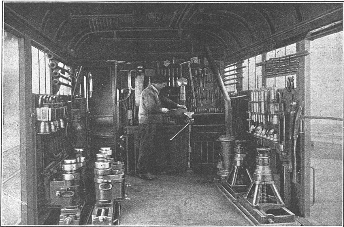
L'INTÉRIEUR D'UN WAGON DE SECOURS COMPORTE UN IMPORTANT OUTILLAGE
