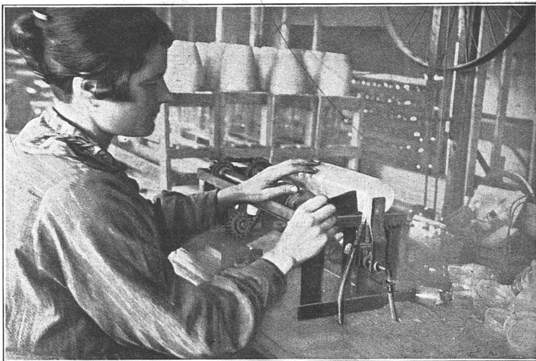
FIG. 2. — COUPAGE DU FOND DE LA BOUTEILLE EXTÉRIEURE
