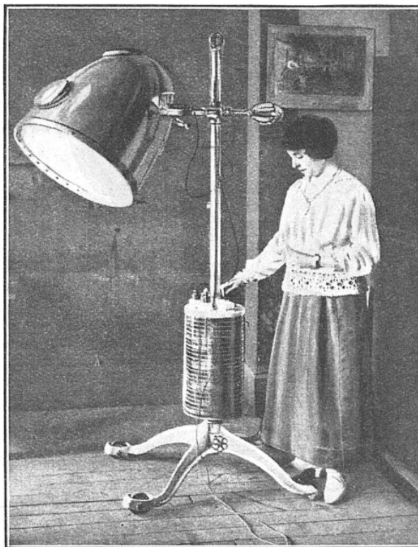
FIG. 1. — LA LAMPE A VAPEUR DE MERCURE DESTINÉE AU TRAITEMENT DE CERTAINES AFFECTIONS PAR L'ACTINOTHÉRAPIE (TYPE CONSTRUIT POUR LES HOPITAUX)
