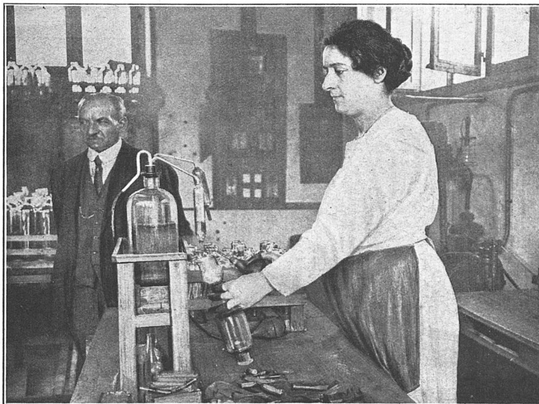
FIG. 5. — REMPLISSAGE DE LA DOUBLE PAROI POUR L'ARGENTURE
