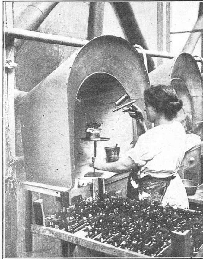
UN POSTE DE PEINTURE A L'AÉROGRAPHE DES JOUETS MÉCANIQUES
