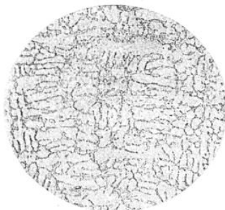
ALLIAGE ALUMINIUM-CUIVRE (CUIVRE : 14 %) POUR PISTONS DE MOTEURS (GROSSISSEMENT FAIBLE)
