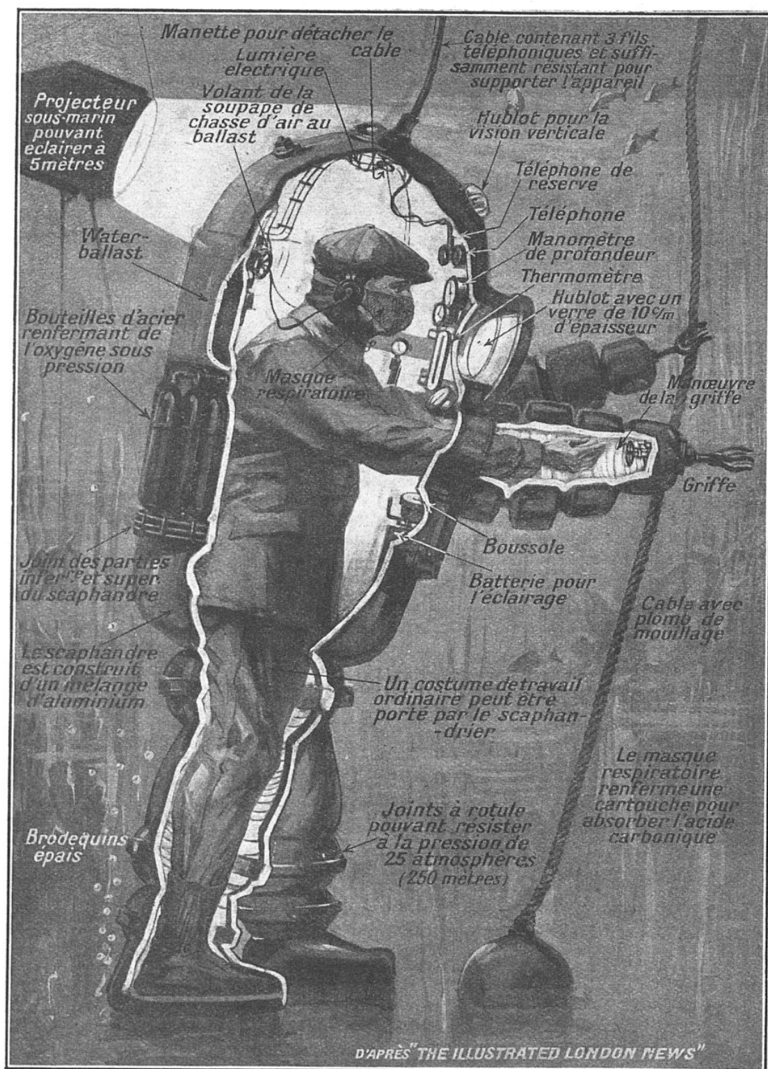
FIG. 13 bis. — L'APPAREIL ALLEMAND UTILISÉ POUR LES PLONGÉES DE GRANDE PROFONDEUR
