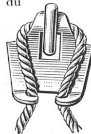
CET APPAREIL EMPÊCHE TOUT GLISSEMENT DU CORDON SOUTENANT LE TABLEAU
