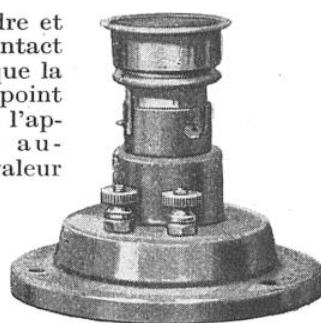
LORSQUE LA MATIÈRE SPÉCIALE CONTENUE DANS LA DOUILLE FOND, UNE SONNERIE RETENTIT
