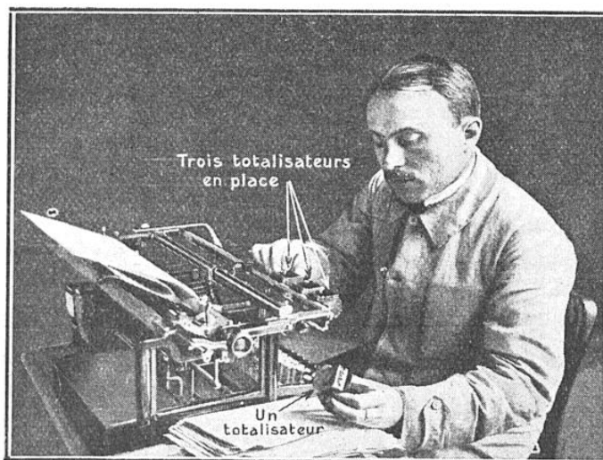
MACHINE « REMINGTON ». MISE EN PLACE D'UN TOTALISATEUR
