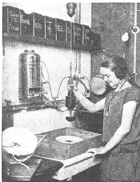
LE LAVE-TOUT C'est le plus simple appareil pour laver tous les ustensiles de cuisine. Il comporte un jeu de brosses interchangeable.
