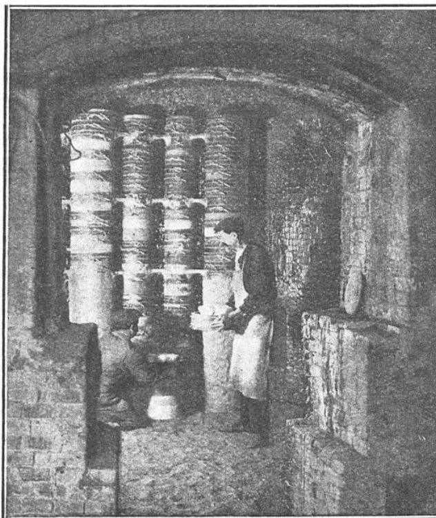
FIG. 10. — ENTASSEMENT DES CASETTES DANS UN FOUR
