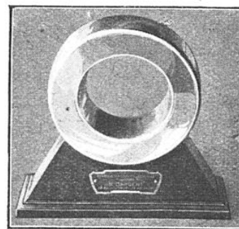
APPAREIL À AIMANTER ET À DÉSAIMANTER
