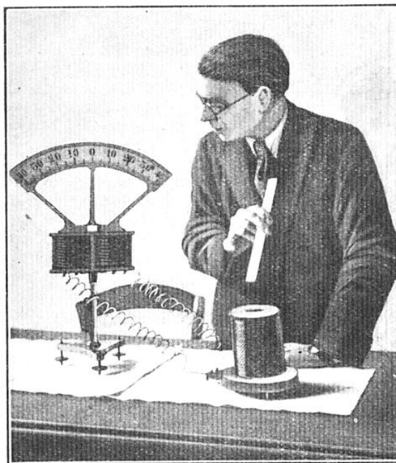
EXPÉRIENCE DE FARADAY SUR L'INDUCTION En approchant un aimant d'une bobine on produit un courant qui fait dévier un galvanomètre
