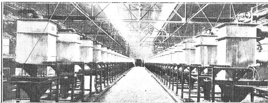
FIG. 1. — TRANSFORMATION DU GAZ AMMONIAC EN ACIDE AZOTIQUE
