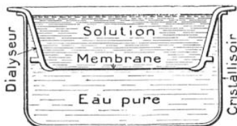
FIG. 2. — COUPE D'UN DIALYSEUR
