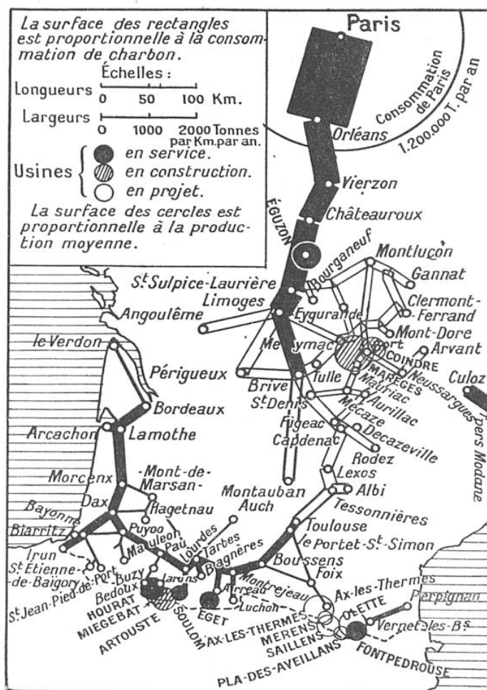
CARTE GÉNÉRALE DE L'ÉLECTRIFICATION DES RÉSEAUX DE CHEMINS DE FER FRANÇAIS
