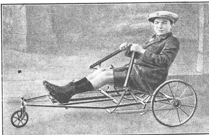
CET APPAREIL, L'« AVIRETTE », PERMET DE SE DÉPLACER SUR LA ROUTE EN EFFECTUANT LES MÊMES MOUVEMENTS QUE SUR UN CANOT
