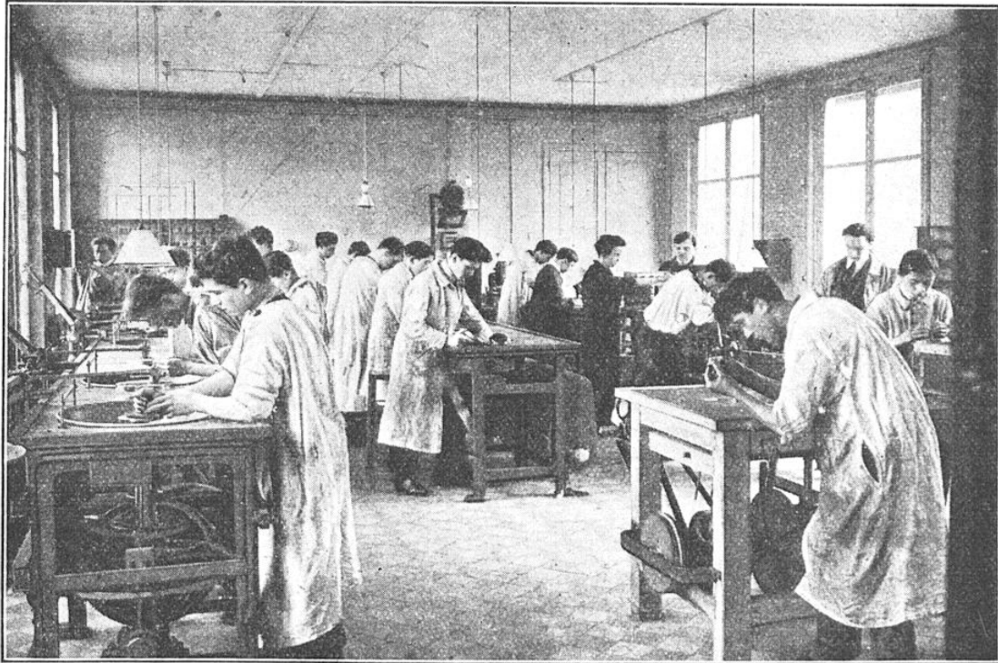
UN DES ATELIERS OU LES ÉLÈVES DE L'INSTITUT D'OPTIQUE APPRENNENT À TRAVAILLER LE VERRE DESTINÉ À LA FABRICATION DE LENTILLES, DE PRISMES, ETC., POUR LES INSTRUMENTS D'OPTIQUE
