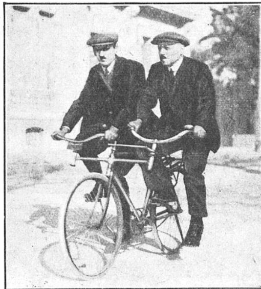
CETTE BICYCLETTE, SUR LAQUELLE DEUX PERSONNES PEUVENT PÉDALER CÔTE À CÔTE, SE TRANSFORME AISÉMENT EN UN VÉLO ORDINAIRE
