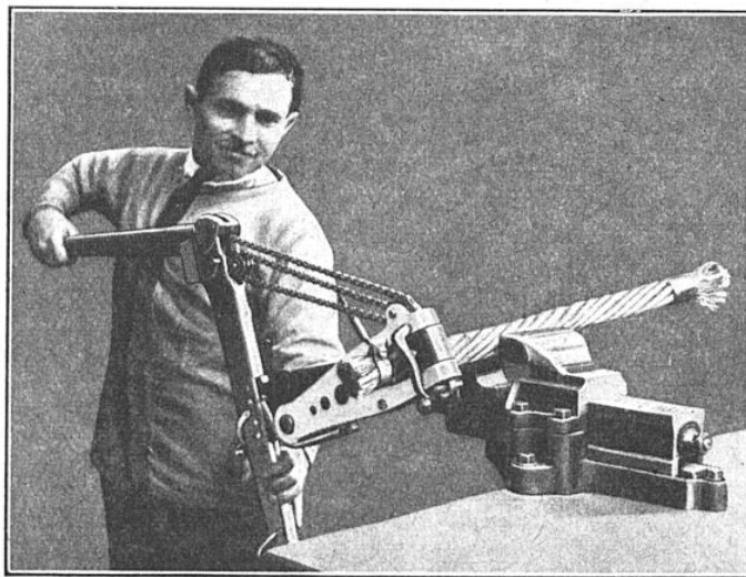
COMMENT ON MANŒUVRE LA CISAILLE POUR COUPER UN CÂBLE
