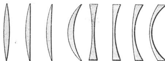
FIG. 39 ET 40. — DU VERRE BICONVEXE OU BICONCAVE AU VERRE CONVEXE-CONCAVE
