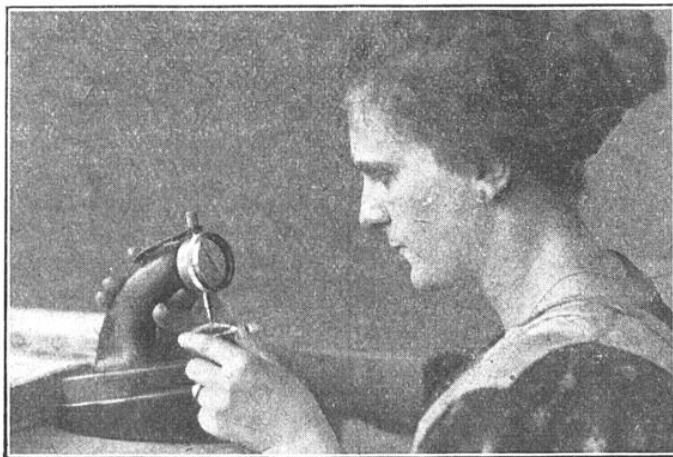
COMMENT ON MESURE L'ÉPAISSEUR DES VERRES TERMINÉS
