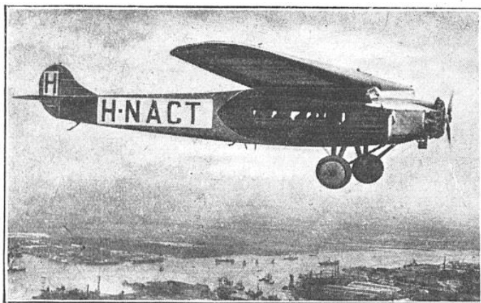
AVION DE TRANSPORT « FOKKER » F.-VII, A MOTEUR « JUPITER » DE 400 CH
