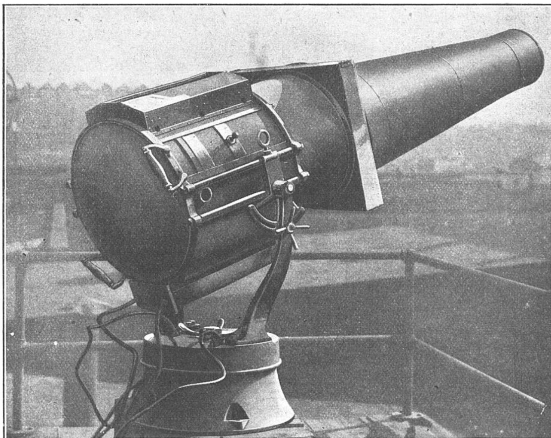
LE CANON PROJECTEUR AMÉRICAIN DESTINÉ A TRACER SUR LES NUAGES LES ENSEIGNES LUMINEUSES JUSQU'À UNE DISTANCE DE 8 KILOMÈTRES
