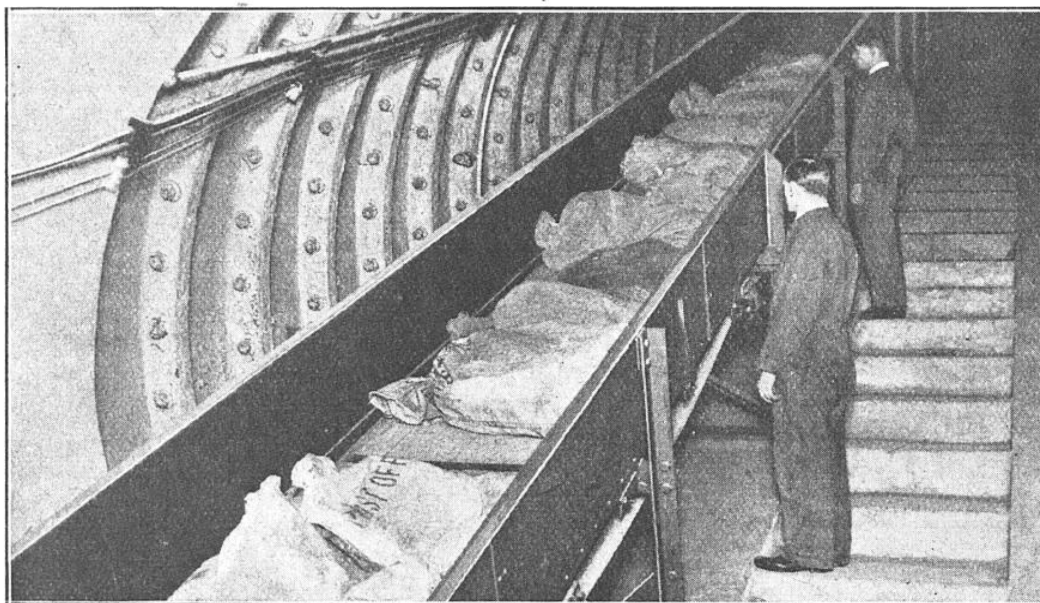
UN TRANSPORTEUR A COURROIE AMÈNE A QUAI LES SACS POSTAUX
