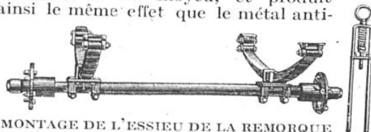
MONTAGE DE L'ESSIEU DE LA REMORQUE
