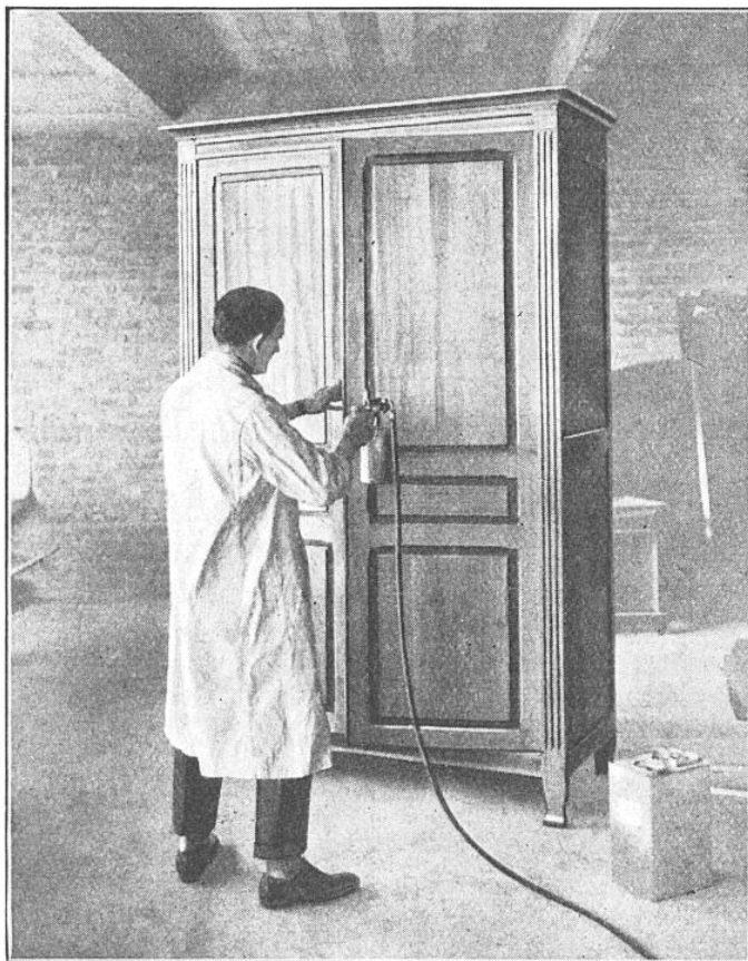
COMMENT ON APPLIQUE LE « CIRÉ NITROLAC » AU PISTOLET, POUR RENDRE LES MEUBLES INALTÉRABLES A L'EAU
