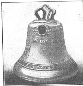
FIG. 1. — LA FUSION DE CETTE CLOCHE, FRAPPÉE PAR LA FOUDRE, EST UNE PREUVE DE LA GRANDE INTENSITÉ DE COURANT QUI CIRCULE DANS L'ÉCLAIR
