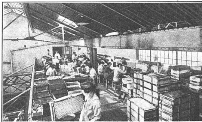
L'ATELIER DE MONTAGE DES BATTERIES DE PILES
