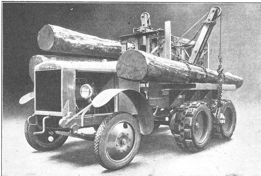
CAMION SIX ROUES « CHENARD-WALCKER » MUNI DE PALANS PERMETTANT DE CHARGER RAPIDEMENT DE GROSSES PIÈCES DE BOIS
