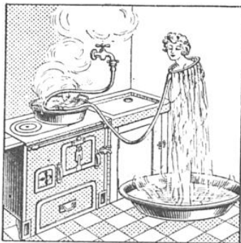
L'APPAREIL RELIÉ A L'EAU FROIDE ET PLONGÉ DANS UN RÉCIPIENT D'EAU CHAUDE OPÈRE LE MÉLANGE ET DONNE DE L'EAU TIÈDE
