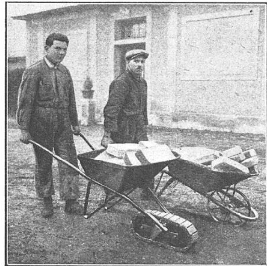
SUR UN TERRAIN MOU, LA ROUE DE LA BROUETTE ORDINAIRE S'ENFONCE, TANDIS QUE LA CHENILLE CIRCULE FACILEMENT
