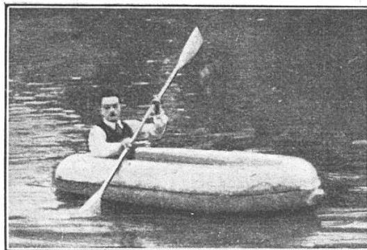
SORTE DE GROS PNEUMATIQUE GONFLÉ À BASSE PRESSION, LA « MOUETTE » EST INSUBMERSIBLE. REPLIÉE, ELLE TIENT DANS UN HAVRESAC
