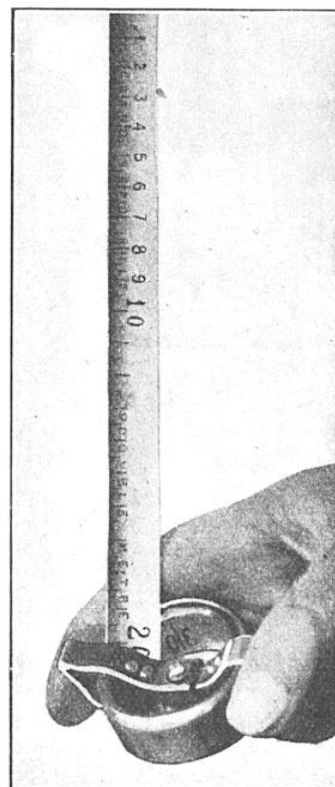
LE DOUBLE MÈTRE MÉTALLIQUE « FARRAND RAPID RULES » SE ROULE DANS UN ÉTUI COMME UN MÈTRE À RUBAN
