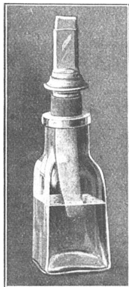
ON MOUILLE LES ENVELOPPES A COLLER AU MOYEN DE LA MÈCHE DE FEUTRE
