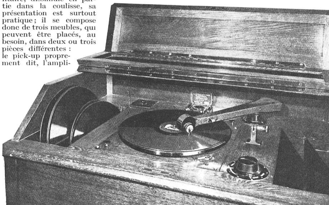
FIG. 1. — PARTIE SUPÉRIEURE DU PUPITRE SUPPORTANT LE DIAPHRAGME ÉLECTRIQUE « LA VOIX DE SON MAÎTRE »
