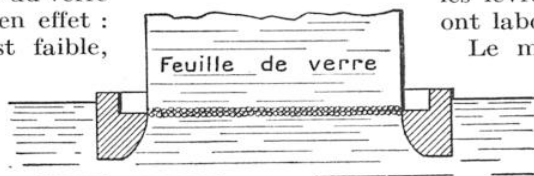
FIG. 11. — COUPE LONGITUDINALE DE LA DÉBITEUSE FOURCAULT, MONTRANT LA FEUILLE DE VERRE EN TRAIN DE S'ÉLEVER HORS DE LA NAPPE EN FUSION
