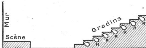
FIG. 13. — LE THÉÂTRE ANTIQUE Cette coupe verticale montre en R, la disposition des résonateurs dont parle Vitruve.
