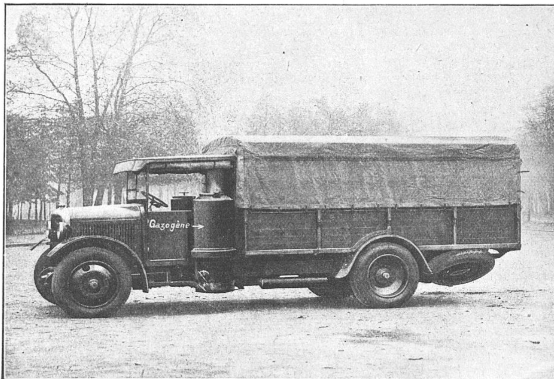
TYPE DE CAMIONNETTE BACHÉE, A GAZOGÈNE, DE 4.500 KILOGRAMMES DE CHARGE UTILE
