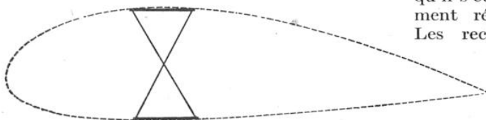
L'AILE ÉPAISSE TELLE QUE LA THÉORIE DU DOCTEUR JUNKERS PERMET DE LA CONCEVOIR
