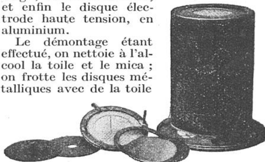
L'OZONISEUR MONTÉ (A DROITE) ET LES PIÈCES DÉTACHÉES (A GAUCHE)
