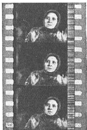
FIG. 11. — FILM SONORE ENREGISTRÉ PAR LE PROCÉDÉ A DENSITÉ VARIABLE
