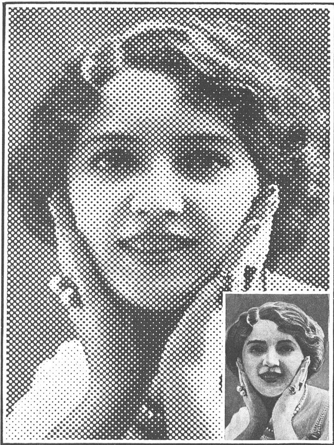
FIG. 7. — VOICI COMMENT APPARAÎT UNE ÉPREUVE DE SIMILIGRAVURE FORTEMENT GROSSIE Il suffit de regarder cette épreuve à une distance convenable pour que les taches, ou plus exactement les points noirs et blancs, donnent l'impression des ombres et des lumières comme sur la photo placée en bas et à droite, obtenue avec la trame 120 employée dans La Science et la Vie.
