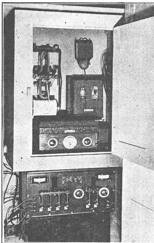
FIG. 3. — POSTE DE COMMANDE D'ALARME ET D'ENREGISTREMENT DU « SISMOS », APPAREIL DIT « A TRÉPIDATION »
