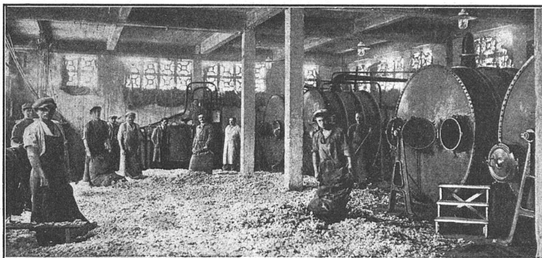
FIG. 8. — TRAITEMENT DES ROSES PAR DES SOLVANTS VOLATILS POUR OBTENIR L'ESSENCE DE ROSES
