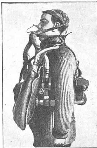
APPAREIL ANGLAIS « PROTO » UTILISÉ DURANT LA GUERRE (Circuit fermé, à oxygène.)
