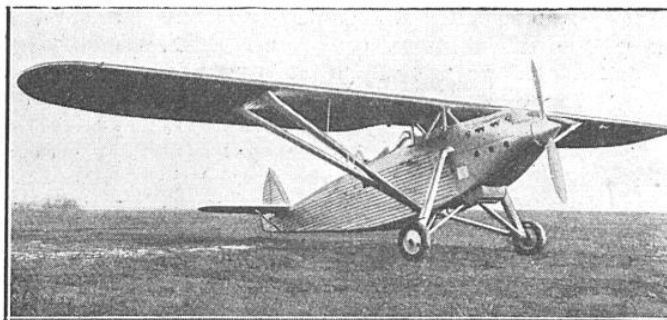
AVION « POTEZ 39-A2 », ENTIÈREMENT MÉTALLIQUE, DONT LA STRUCTURE ET LE REVÊTEMENT DES AILES ET DU FUSELAGE SONT EN DURALUMIN
