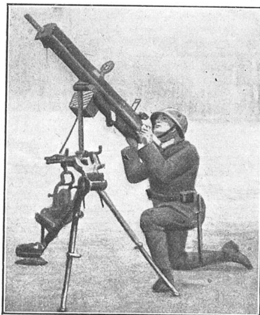
MITRAILLEUSE LOURDE ALLEMANDE DE 20 MM POINTÉE CONTRE AVION (TYPE EN SERVICE)
