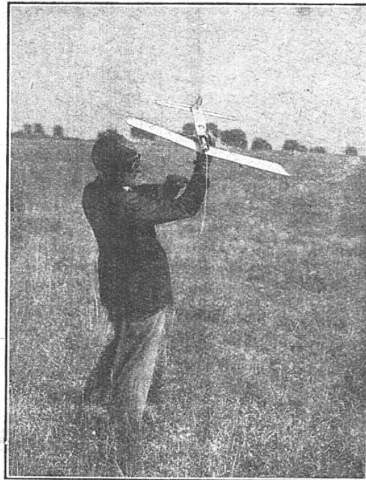
CE PETIT MODÈLE D'AVION PROPULSÉ PAR FUSÉES A DONNÉ, AUX ESSAIS, EN ALLEMAGNE, MALGRÉ SA GRANDE SIMPLICITÉ DE CONSTRUCTION, LES RÉSULTATS LES PLUS ENCOURAGEANTS.
