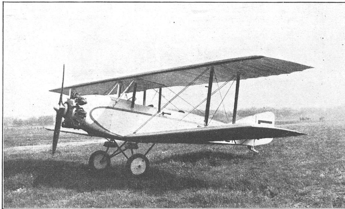
AVION « CAUDRON C. 270 », ÉQUIPÉ D'UN MOTEUR SALMSON DE 95 CHEVAUX
