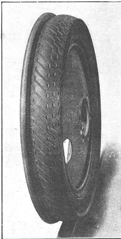
LE PNEUMATIQUE MONTÉ SUR LA ROUE, DISQUE D'ACIER EMBOUTI A gauche, le boudin d'acier qui guide la roue sur le rail.
