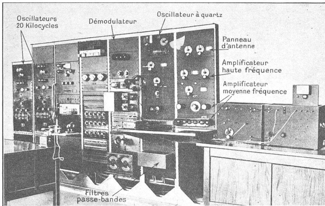
APPAREILLAGE DE LA STATION RÉCEPTRICE DE TRAPPES (PRÈS DE VERSAILLES), POUR LES ONDES COURTES DE 30 MÈTRES A FRANGE UNIQUE
