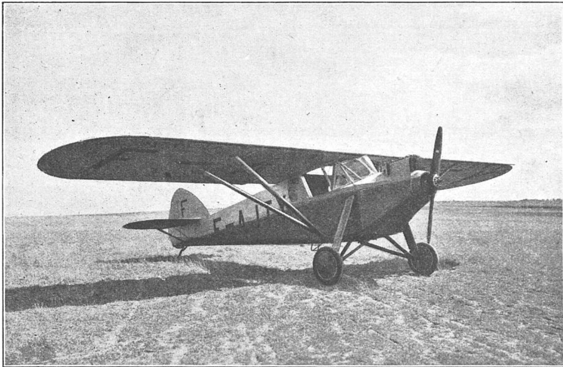
AVION « POTEZ », TYPE 36 ÉQUIPÉ D'UN MOTEUR RENAULT DE 95 CHEVAUX
