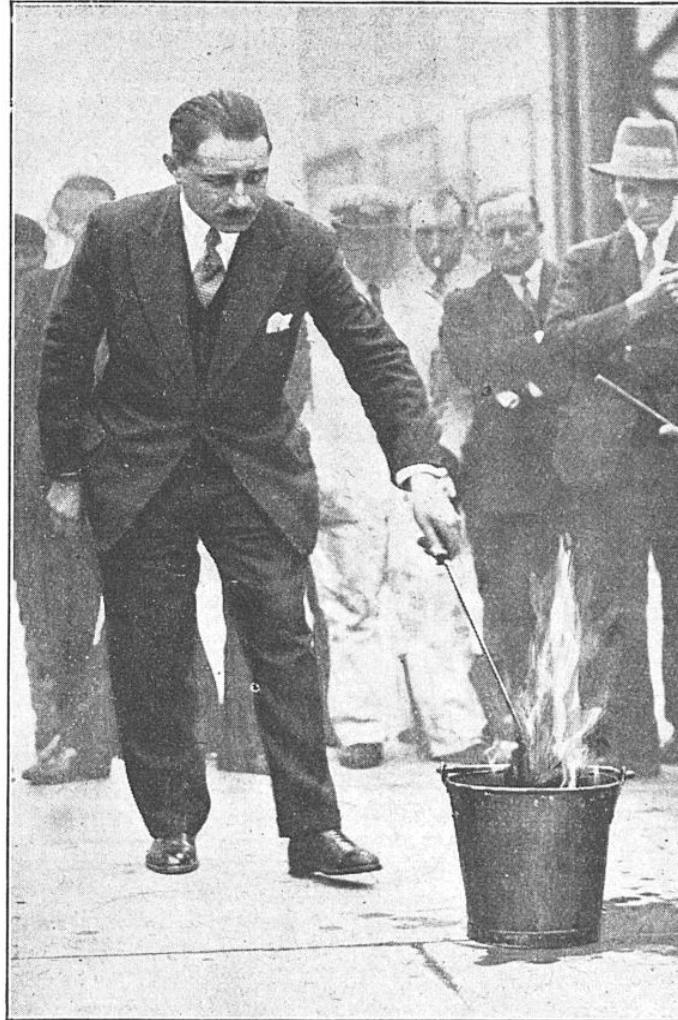
M. BARDEL, DIRECTEUR TECHNIQUE DE L'AIR-UNION, PLONGE UN CHIFFON ENFLAMMÉ DANS UN SEAU D'ESSENCE DE SÉCURITÉ, AFIN DE DÉMONTRER L'ININFLAMMABILITÉ DU PRODUIT. CETTE EXPÉRIENCE FUT RÉPÉTÉE PLUSIEURS FOIS SUR LE TERRAIN DE CROYDON, A LONDRES
