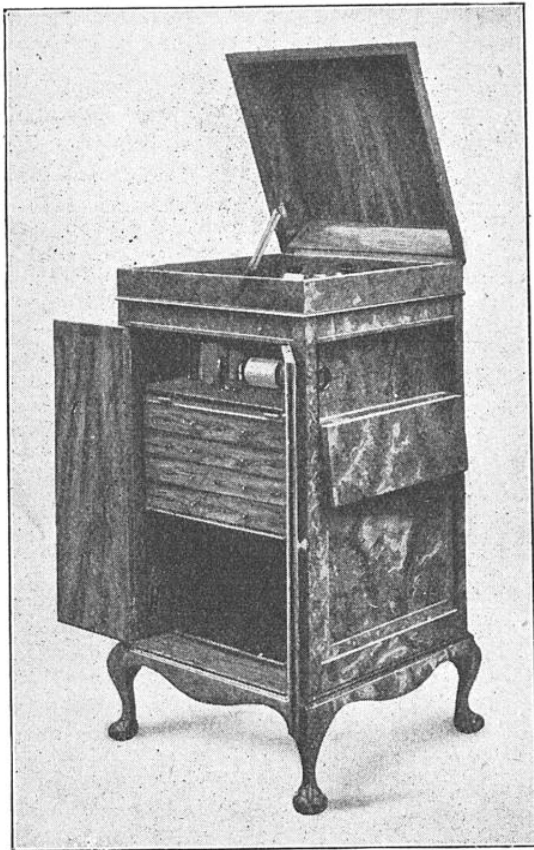
FIG. 2. — VOICI UN ENSEMBLE QUI COMPORTE NON SEULEMENT UN PUISSANT RÉCEPTEUR DE T. S. F. ET UN PHONOGRAPHE A PICK-UP, MAIS ENCORE UN PETIT APPAREIL DE PROJECTION CINÉMATOGRAPHIQUE
