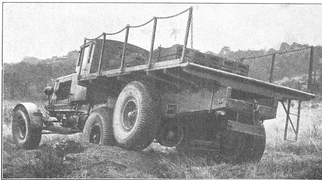
CAMION DE 40 CH A SIX ROUES, DONT QUATRE MOTRICES
