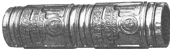
FIG. 3. — CYLINDRE EN ACIER NITRURÉ SERVANT A LA REPRODUCTION DES GRAVURES
